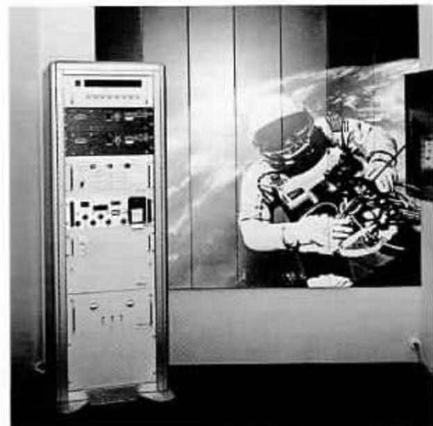
Une des six boîtages à quartz, précisés au 100 000<sup>e</sup> de seconde, livrés à l'ESRO en 1966.
